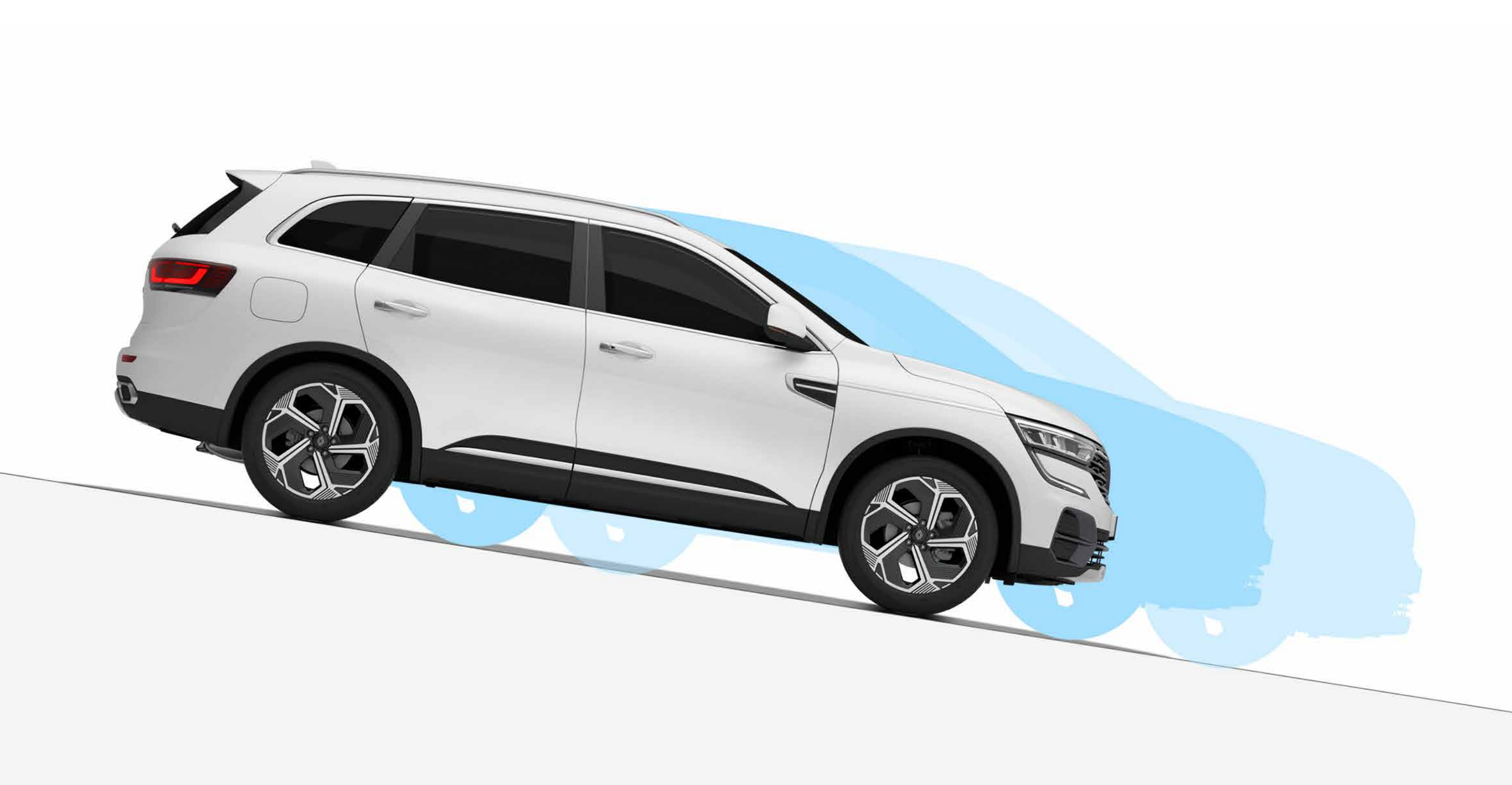
esquema del control de descenso en pendientes
