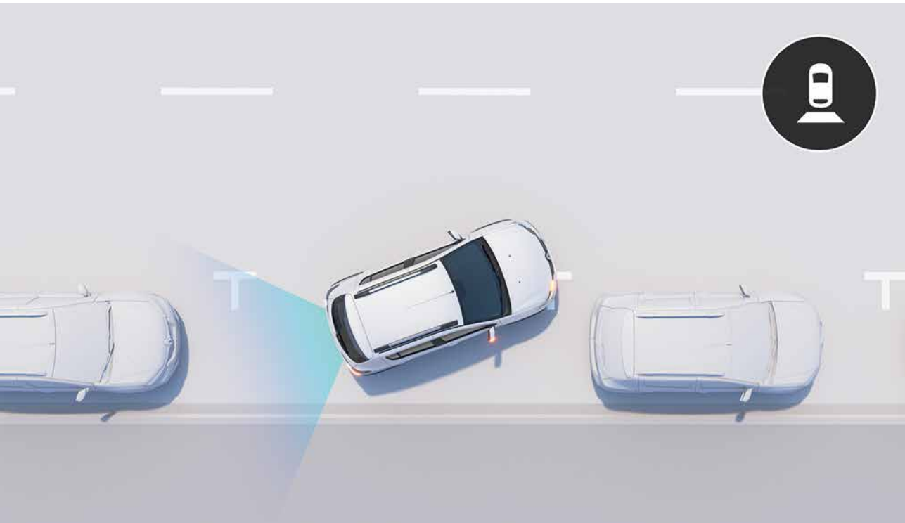
sensor de reversa Los sensores miden la distancia entre el vehículo y un obstáculo. A través de señales acústicas que varían en frecuencia, indican cuando el obstáculo está más cerca.
