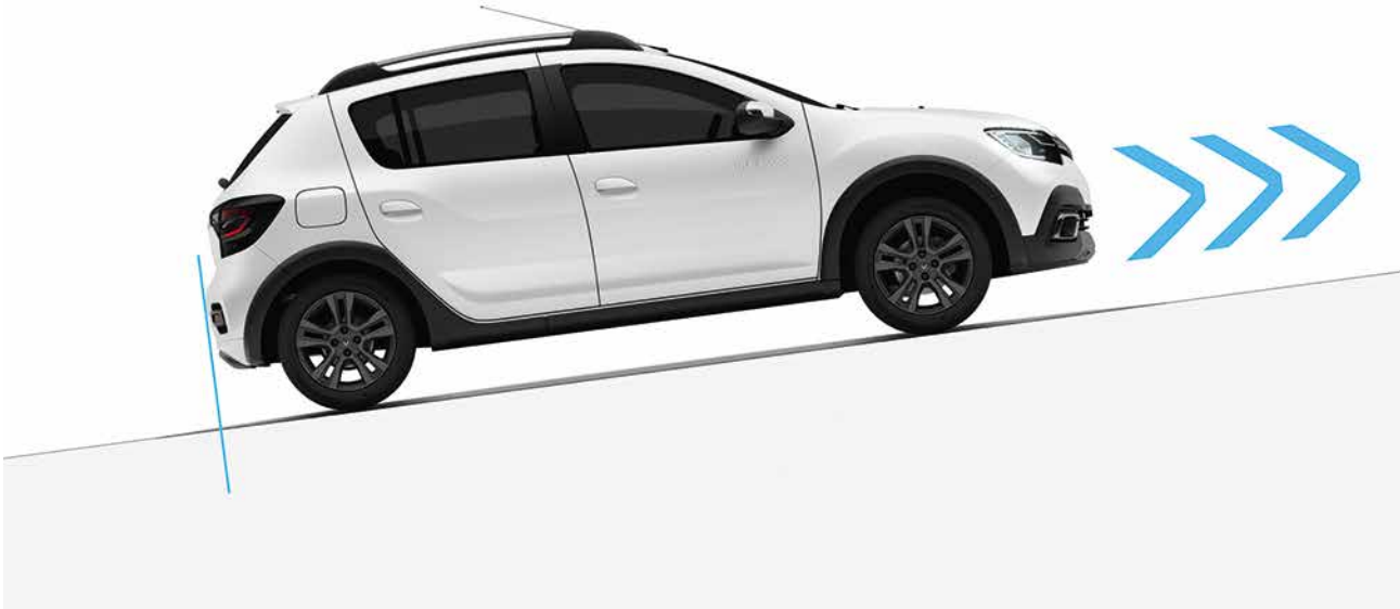
asistente de arranque en pendiente El asistente de arranque en pendiente (HSA) impide durante unos segundos que el vehículo retroceda, lo que facilita la seguridad en el arranque en pendientes.
